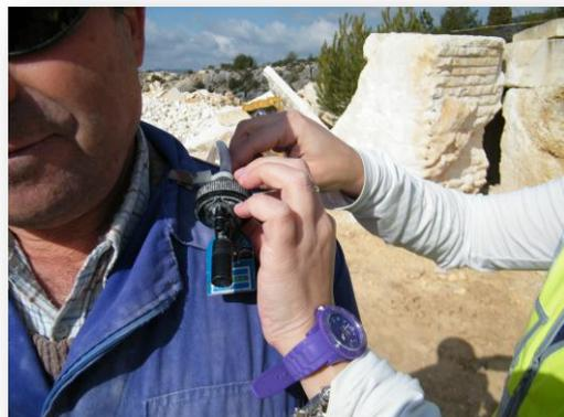
5. Transcurrido el tiempo de muestreo predeterminado (siempre que sea posible se medirá una jornada completa de 8 horas), se para el funcionamiento de la bomba y se anotan los datos siguientes.
