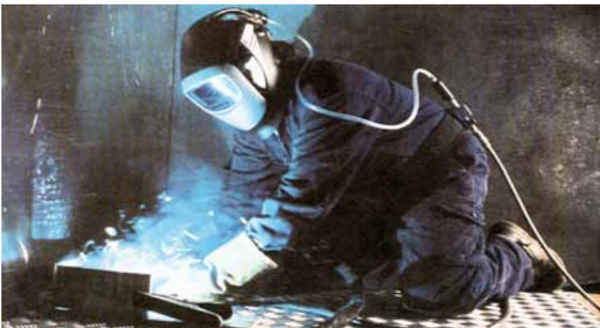
**Pantalla de soldadura asistida con línea de aire.**
