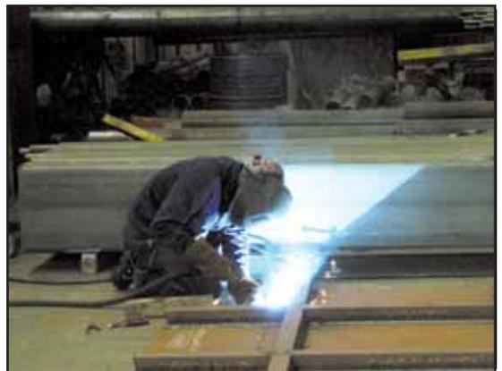
Soldadura en calderería pesada.
