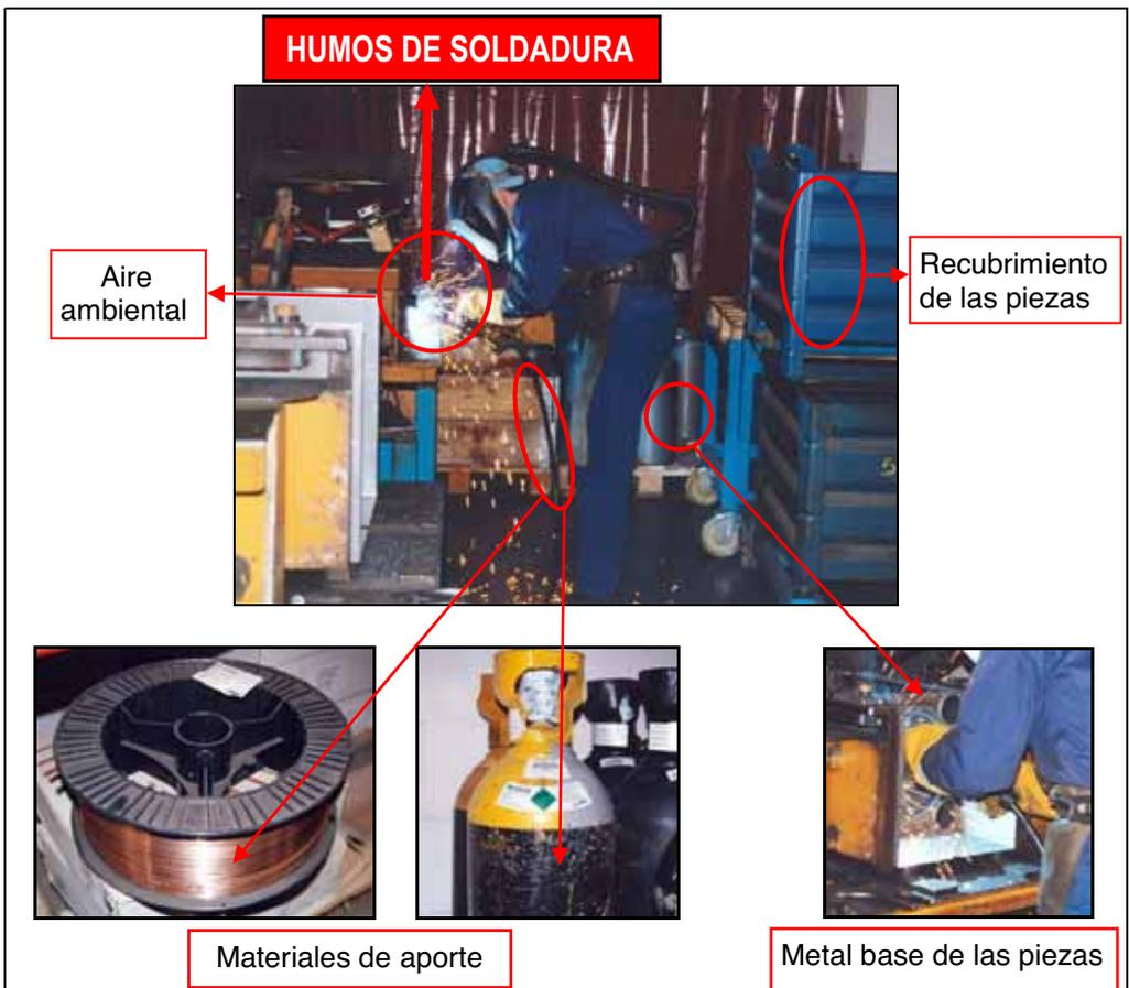
Los humos de soldadura se forman por el calentamiento y la descomposición de los materiales presentes junto al punto de operación.
