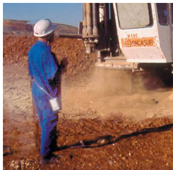
Trabajador equipado con un dispositivo de toma de muestras individual
