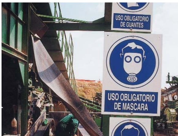
Señal de uso obligatorio de mascarillas protectoras
