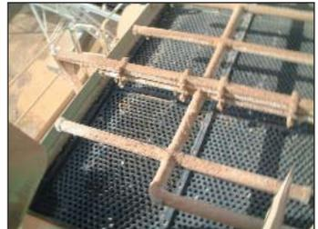
*Sistema de pulverización en una criba*
