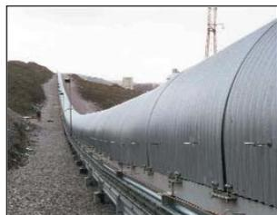
Una alternativa al transporte interno con camiones: cintas transportadoras con capotajes
