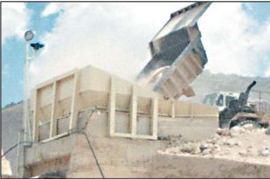
*Dispositivo de atomización con sensores automáticos en la tolva del primario*
