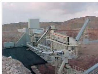
*Instalación con dispositivos de prevención del polvo en los diferentes equipos*
