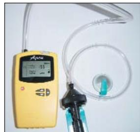
La parte del aparato que contiene al **motor** y a la **bomba** de aspiración se sitúan **en la cintura del trabajador**
