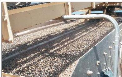
*Criba con realces laterales y sistema de pulverización de agua*
