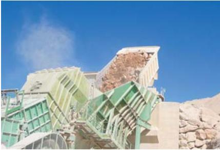
**Revisa las medidas** de seguridad para **impedir la caída de equipos sobre la tolva** durante la descarga
