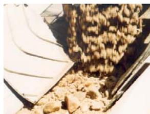
Si es preciso, **repara los realces laterales** de los **puntos de transferencia**
